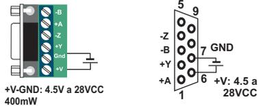
**Conexión RS485+BOR09H** se muestra en la figura que sigue y más abajo la configuración de puentes. Los terminales Y-Z son aquí repeticiones de A-B y pueden usarse como auxiliares.
