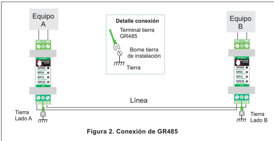
Figura 2. Conexión de GR485
