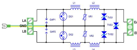
Figura 1: R2218, esquema interno
